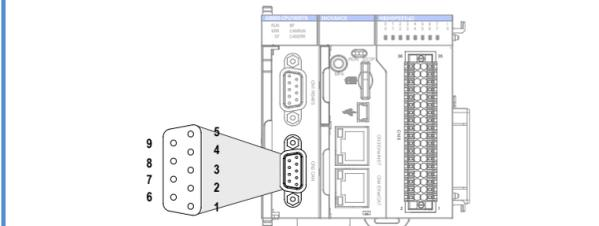
图8 CPU 模块上的 CANopen 端子定义
