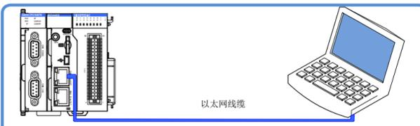
图10 CPU 模块与 PC 连接
