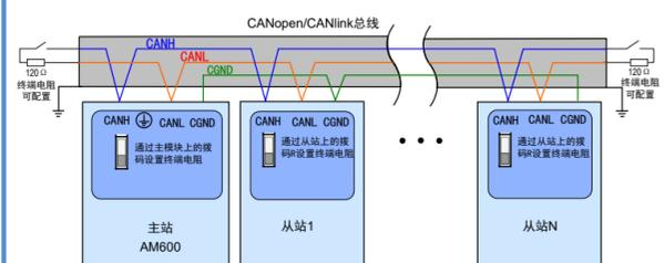
图7 CANopen/CANlink 通讯连接示意图
