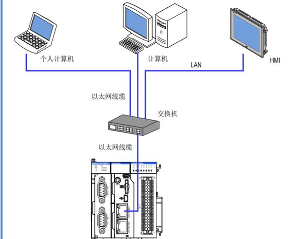
图11 CPU 模块通过交换机与其他设备连接
