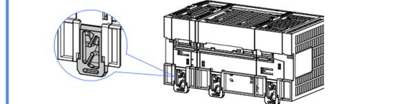
② 如图 A 方向,将模块上侧的固定爪挂到 DIN 导轨上侧,按图中 B 方向用力按压模块组至完全嵌入导轨。
