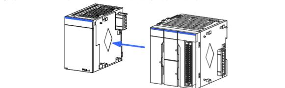
③ 将 CPU 模块上的锁扣按图示方向滑动,完成两个模块的连接与锁定。
