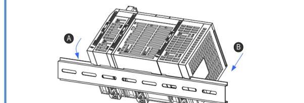
③ 将模块的 DIN 导轨安装用挂钩锁定后,嵌入到 DIN 导轨上。应向上拨入直至发出咔嚓声。此外,手指够不到 DIN 导轨安装用挂钩的情况下,应使用螺丝刀等工具。
