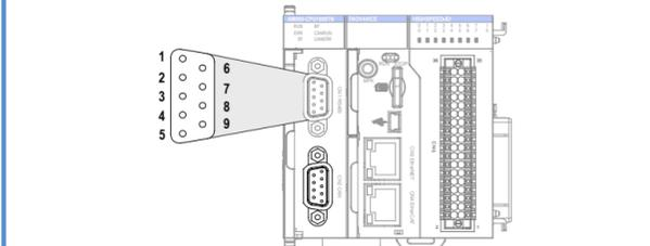
图9 CPU 模块上的 RS485 通讯端子定义
