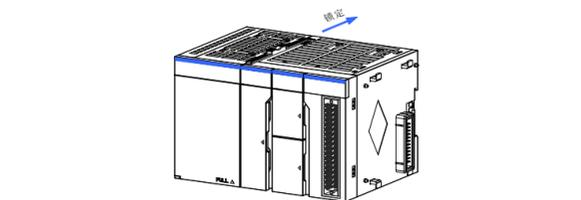
【注意】在 IO 端子排安装到 CN5 之后,请使用 0.2-0.25Nm 扭矩将其进行固定,如下图所示:
