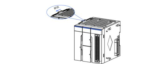
② 将 CPU 模块与电源模块上的连接器完全对接,并使其连接紧密。
